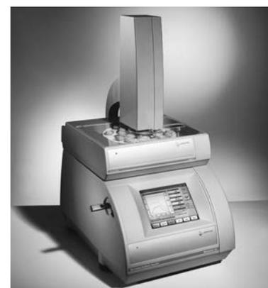
Équipé d'un capteur Infra-rouge et d'un capteur de pression intégré au capot, toutes les mesures essentielles sont enregistrées et affichées tout au long de la synthèse. Le Thermomètre Rubis permet une mesure précise et rapide dans le réacteur. Grâce à un traitement optimal des mesures de température les réactions sont contrôlées avec une grande justesse, limitant les « overshoot ».
